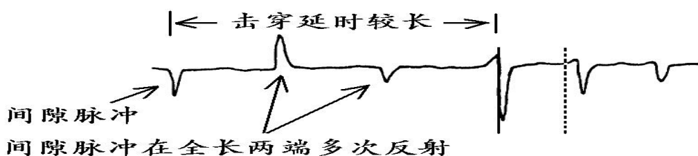
(b) 较长延时的冲闪法波形
