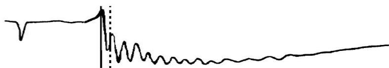
(c) 近距离故障冲闪法波形
