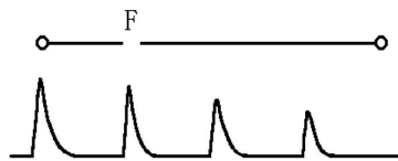
图 3-2-2 断线故障反射波形
