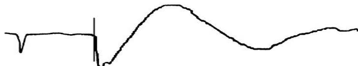
(d) 极近距离端头故障冲闪法波形
