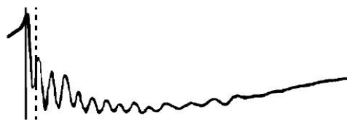
(c) 近距离故障直闪法波形
