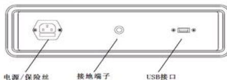
图 1b 变压器绕组变形测试仪后面板图(后面板)
