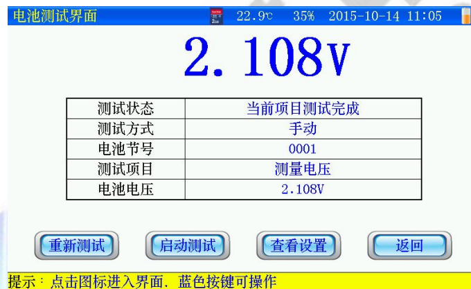
图 3.3.1-1 仅测量电压界面
