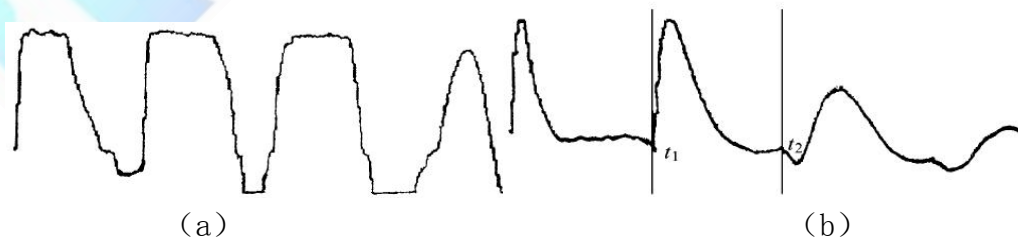
(a) 冲击电压为 20kV 实测波形；(b) 减小输入幅度后的波形
