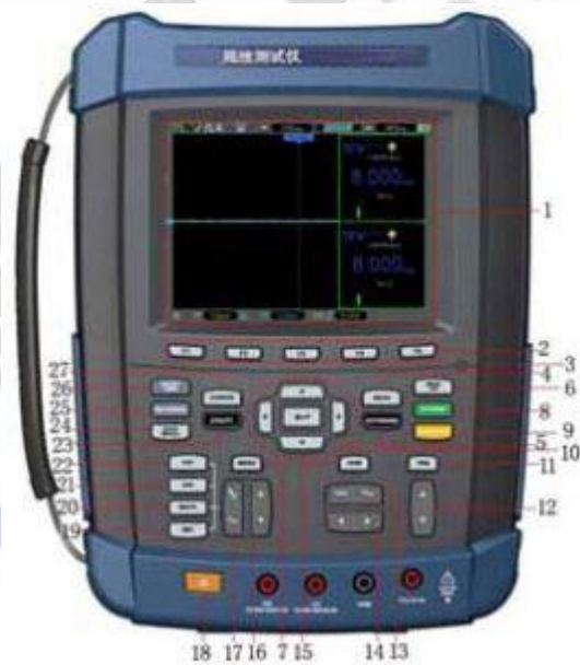
手持式多功能局部放电测试仪主机前面板
