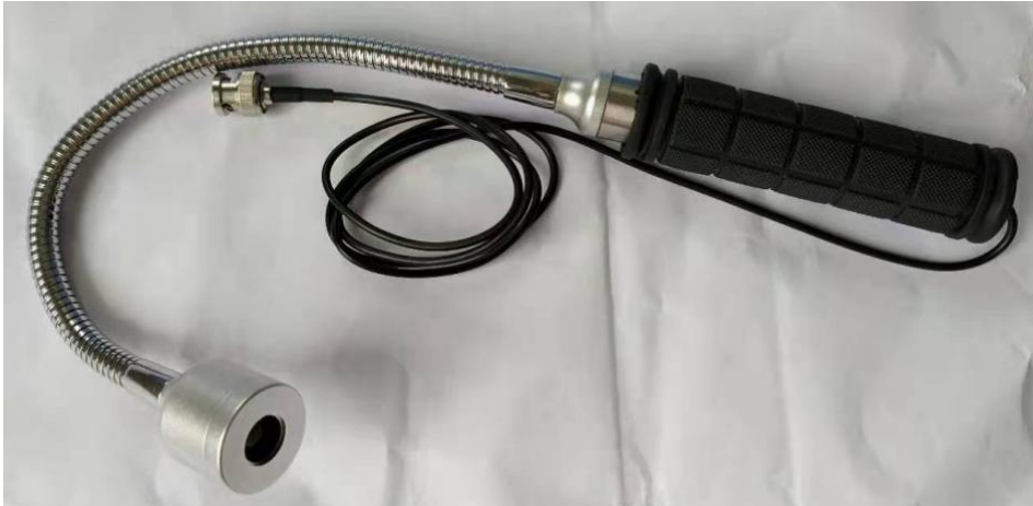
手持式非接触式超声波聚能器（非接触检测电缆、开关柜超声波局放）
