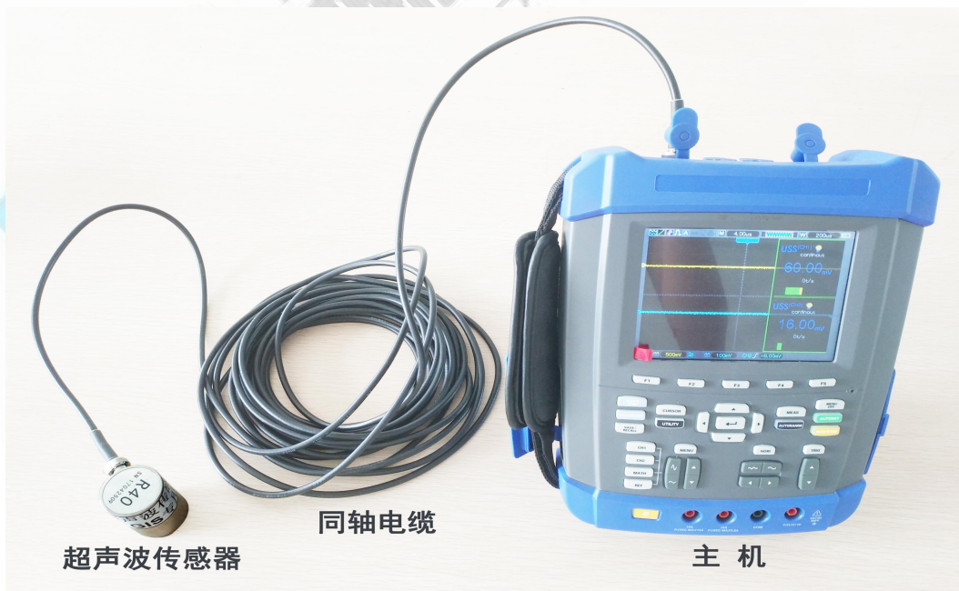
检测变压器、GIS 超声波传感器接线
