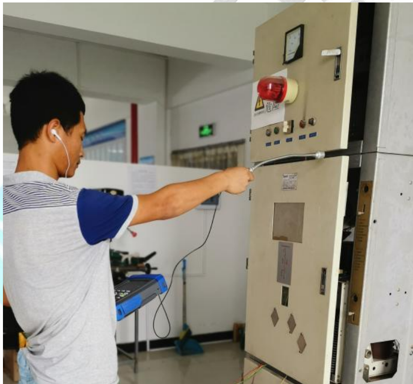
使用手持式非接触式超声波聚能器扫描开关柜
